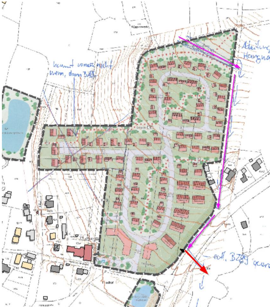
Abbildung 7 Baugebiet mit Maßnahmenskizze, rosa = Graben, Rot = Verrohrung
